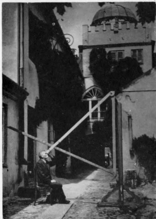
19. Triquetrum Mikołaja Kopernika, rekonstrukcja z 1947 r. Demonstracja sposobu posługiwania się tym przyrządem przez jego rekonstruktora dra Feliksa Przypkowskiego, Jędrzejów
