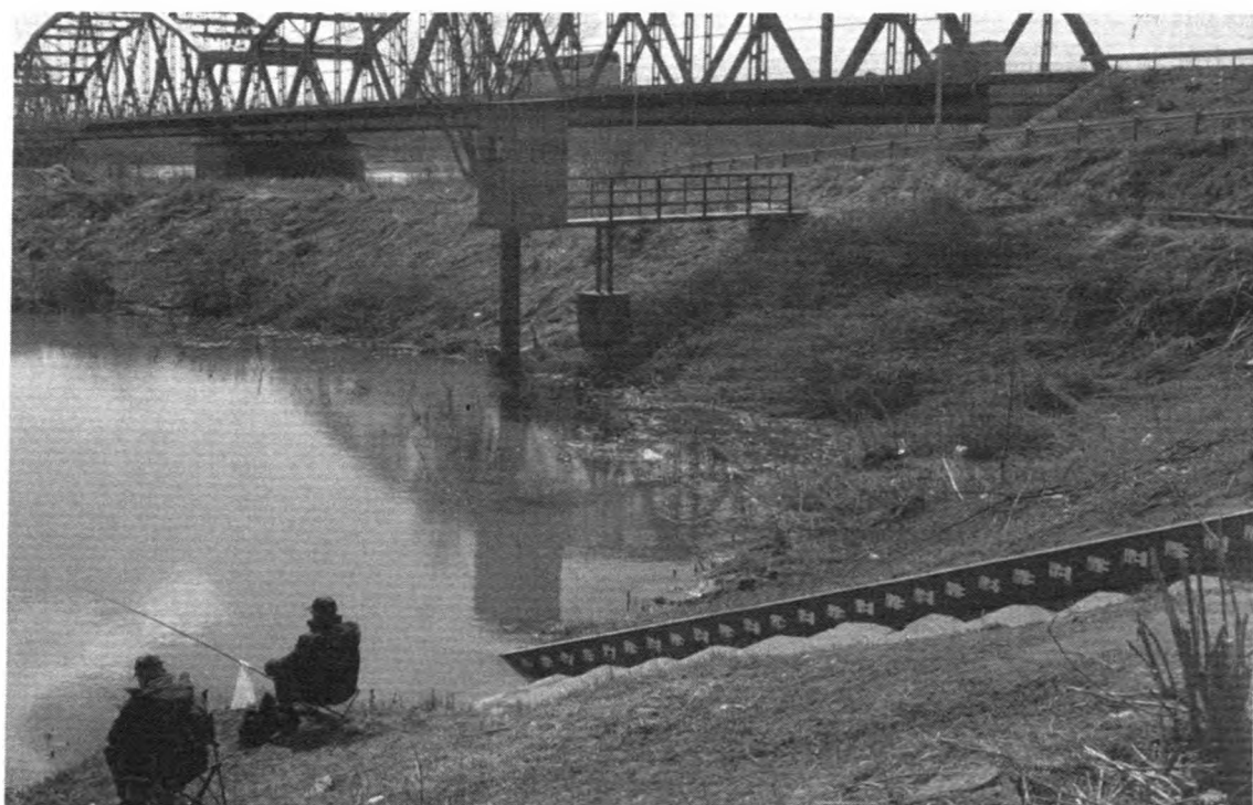
Fotografia 4. Limnigraf i wodowskaz schodkowy na posterunku wodowskazowym Fordon
