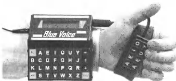
Fig. 7. Central module of the prototype speech-aid system Rys. 7. Moduł centralny prototypowego systemu wspomagania mowy
