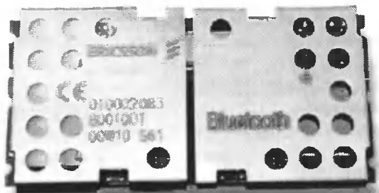
Fig. 6. Complete Bluetooth radio module (ROK101 007, Ericsson) Rys. 6. Kompletny moduł radiowy Bluetooth (ROK101 007, Ericsson)
