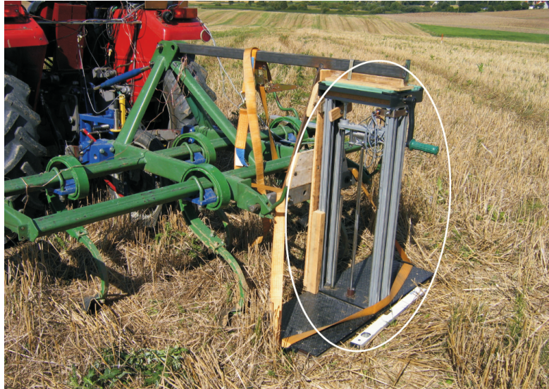
Rys. 6.13. Zwięźłościomierz zamontowany na mobilnym stanowisku badawczym
