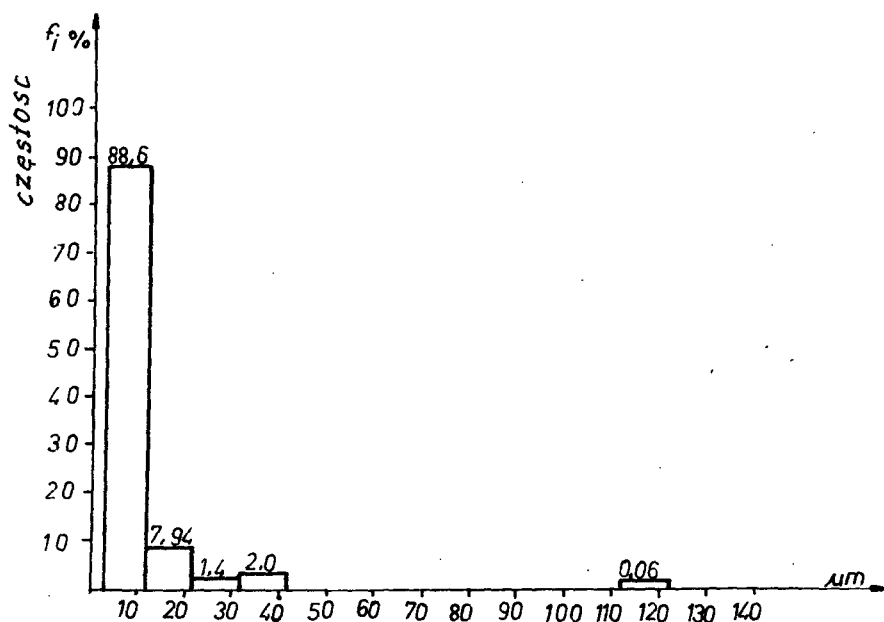
Rys.3. Rozkład grubości wiązek włókien w mieszaninie azbestów po mieszanii przez 210 s w turbomikserze
