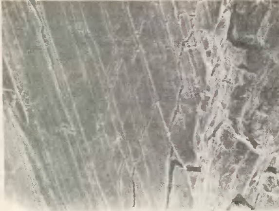
Rys.4.16. Obraz mikrofraktograficzny, grupa 2, próbka K108, \alpha_y = \alpha_{xy} = 180 , powiększenie 480x, powierzchnia zewnętrzna próbki
