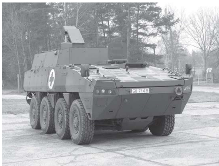
Rys. 6.1. Pojazd AMV 8x8 Rosomak w wersji WEM MED
