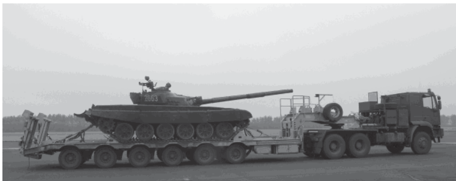
Rys. 9.2. Ciągnik siodłowy Iveco Trakker MP720 z naczepą niskopodwoziową NR600W
