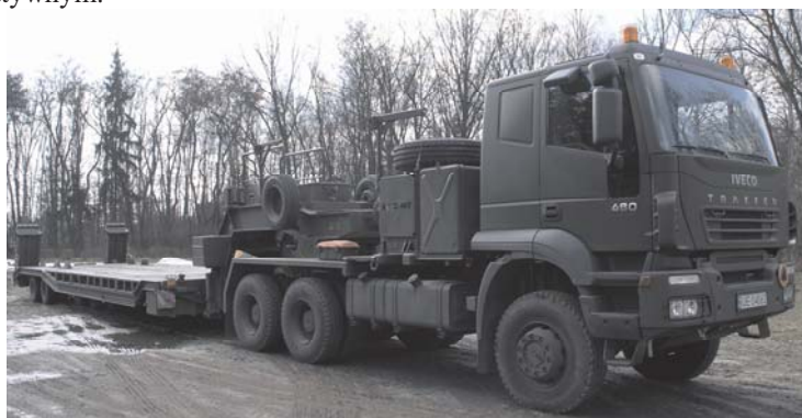
Rys. 9.10. Ciągnik siodłowy Iveco Trakker MP720z naczepą niskopodwoziową NS500Z
