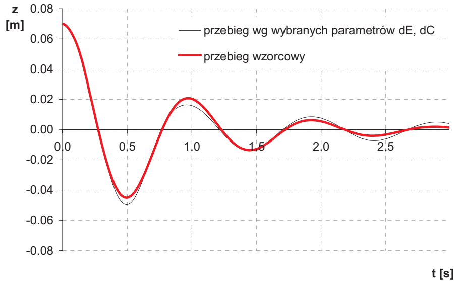
Rys. 7.13. Porównanie charakterystyk tłumienia wzorcowej i uzyskanej dla wybranych parametrów
