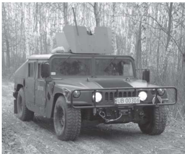
Rys. 5.1. Lekki dwuosiowy pojazd opancerzony HMMWV 1043A ze zmodernizowanym kadłubem
