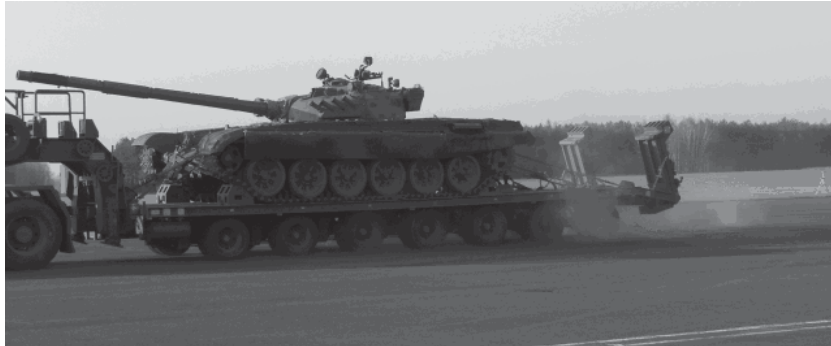
Rys. 9.4. Zestaw hamujący, zastosowanie układu ABS nie wykluczyło możliwości zablokowania kół ostatniej osi
