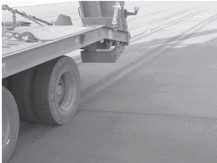
Rys. 9. 5 Zestaw niskopodwoziowy NS700W podczas hamowania, widoczne ślady ogumienia na nawierzchni
