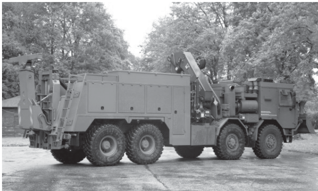
Rys. 3.6. Ciągnik ewakuacji technicznej z opancerzoną kabiną
