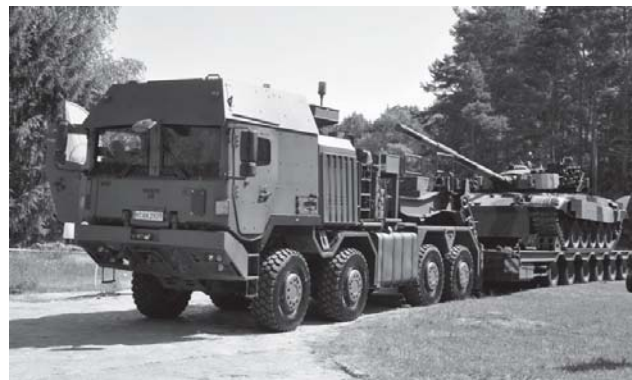
Rys. 3.7. Zestaw do transportu ciężkiej techniki bojowej z opancerzoną kabiną
