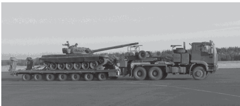
Rys. 9.3. Ciągnik siodłowy Iveco Trakker MP720 z naczepą niskopodwoziową NS700W
