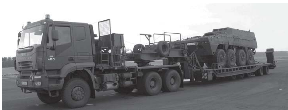
Rys. 9.1. Ciągnik siodłowy Iveco Trakker MP720 z naczepą niskopodwoziową NS500Z
