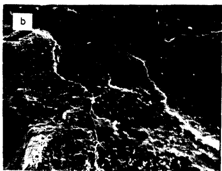
Rys.28. Mikrofotografia kaolinu z Sedlec po f = 1 cyklu mroźnienia w temperaturze \theta_z = -20^\circ\text{C} , widok na powierzchnię graniczną szkieletu mineralnego, prostopadłe od strony mikrosoczewki lodowej:
