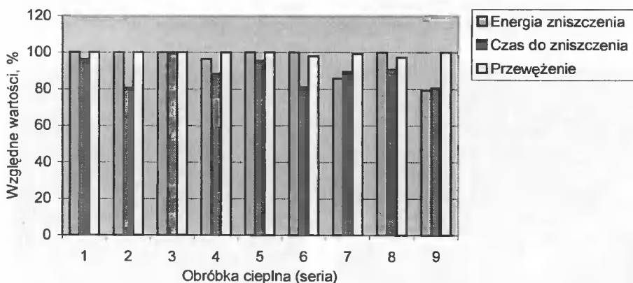
Rys. 3. Względna energia zniszczenia, czas do zniszczenia i przewężenie mierzone w próbie stałego wolnego rozciągania
