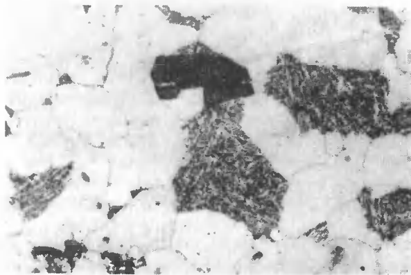
Rys. 1. Struktura materiału A. Traw. azotalem. Pow. 500x
