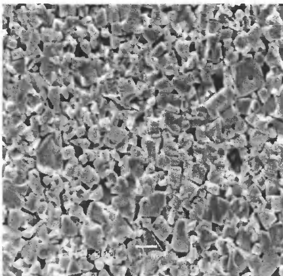
Rys. 2. Struktura narzędzia skrawającego wykonanego z węgla spiekane. Trawienie odczynnikami podanym w tabeli 2 (PN-ISO 4499). Pow. 10000x
