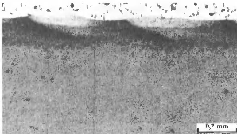
Rys. 4. Warstwa wierzchnia po laserowym zahartowaniu przy następujących parametrach: P = 2000 W, v_c = 10,8 m/min, f_t = 0,5 mm, d_t = 2 mm, x = 0,75
