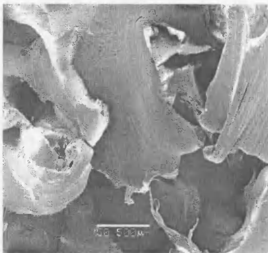
Rys. 5. Przełom kompozytu polimerowego napełnionego cząstkami gumy. Powierzchnia przełomu napyłona węglem i platyną. Pow. mikroskopowe 50x
