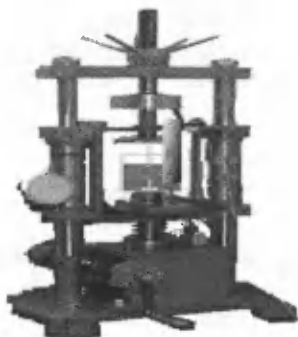
Rys. 1. Widok komory pomiarowej do badań przy stałym wolnym rozciąganiu
