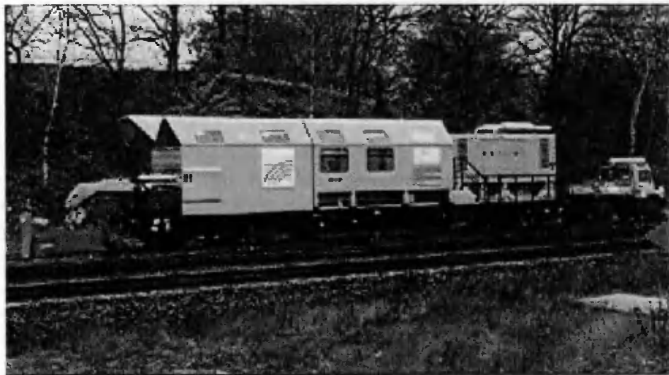
Rys. 10. Przejezdna zgrzewarka Railtech Schlatter typu Supra-Railflex [3]
