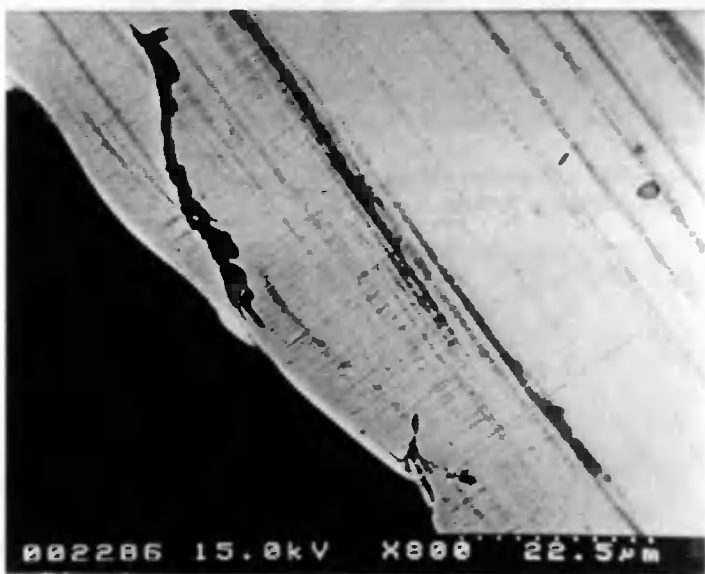
Rys. 12. Szyna UIC. Typowe mikropęknięcia zmęczeniowe w ww. Pow. 500x
