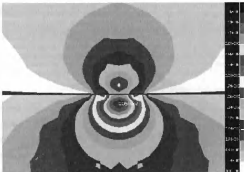
Rys. 2. Przykład rozkładu naprężeń zredukowanych dla P = 40 kN
