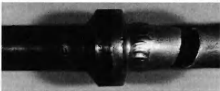
Rys. 11. Połączenie rury stalowej z rurą aluminiową za pomocą łącznika po przeprowadzonej próbie rozciągania
