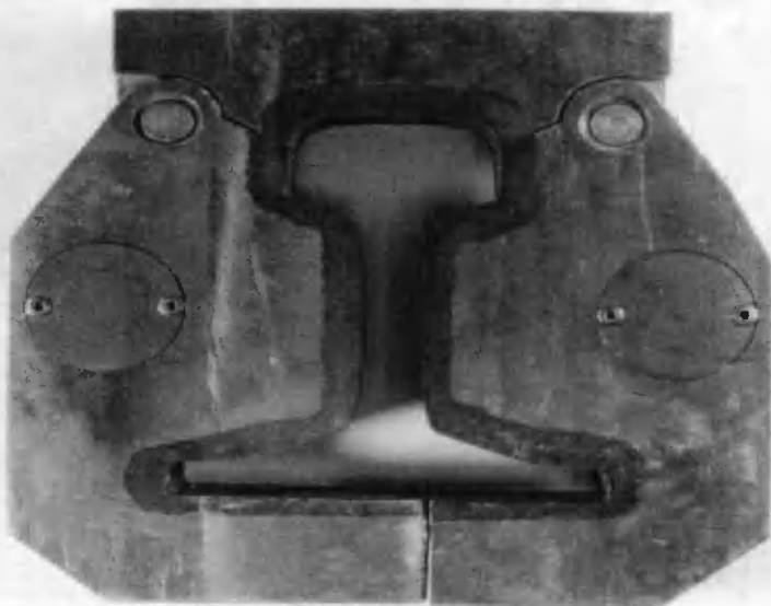
Rys. 16. Nóż do obcinania wypływki zgrzeiny typu ARBENT 12 produkcji firmy ARBENT Kraków [7]
