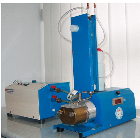
Fot. 4.2. Zestaw do pomiaru wodochłonności [49]
