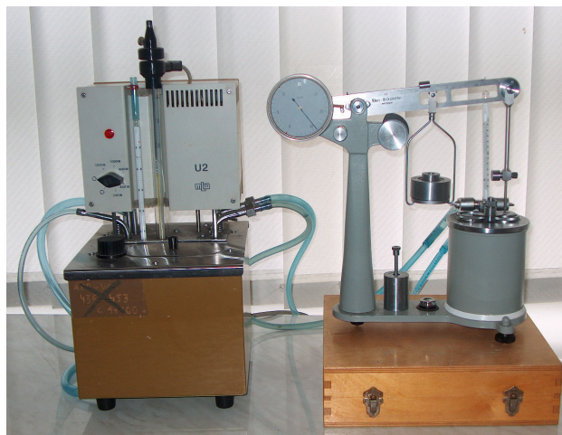
Fot. 4.1. Stanowisko do badania lepkości ciasta, reowiskozymetr Hoepplera z termostatem laboratoryjnym
