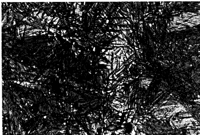
Rys. 34g. Struktura żeliwa sferoidalnego po hartowaniu z temperatury T_{\gamma} = 950 °C, podchłodzeniu do temperatury T_{pi} = 250 °C i wygrzewaniu w czasie \tau_{pi} = 120 min. Trawienie nitałem. Pow. 500x
