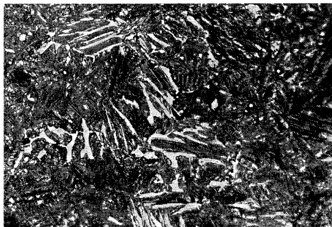
Rys. 35d. Struktura żeliwa sferoidalnego po hartowaniu z temperatury T_y = 830 °C, podchłodzeniu do temperatury T_{pt} = 350 °C i wygrzewaniu w czasie \tau_{pt} = 240 min. Trawienie nitałem. Pow. 500x
