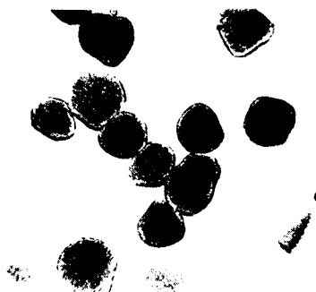
Rys.3 Ziarna PCW B - 68, poddane działaniu DOF w temperaturze 388 K, po upływie 1 minuty; światło przechodzące, powiększenie 100 x
