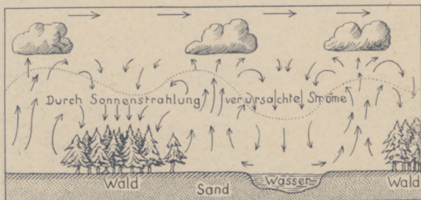
Abb. 14. Entstehung der Schönwetterwolken. ..... Flugzeugbahn. Die vier Pfeile über den Wolken deuten die allgemeine Strömung an.
