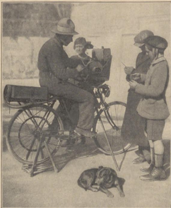
Ein italienischer Scherenschleifer, der den Schleifstein durch das Hinterrad des Fahrrades antreibt
