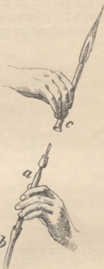
Fig. 79. Durch Luft entleuchtete Gasflamme.
