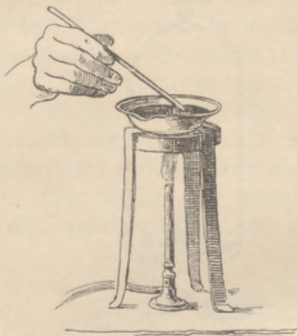
Fig. 25. Erhitzen von Quecksilber an der Luft.
