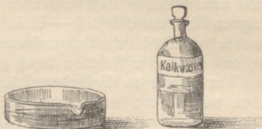
Fig. 35. Kalkwasser trübt sich an der Luft.
