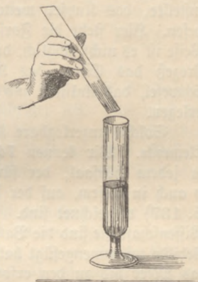
Fig. 21. Abscheidung von Kupfer durch Eisen.
