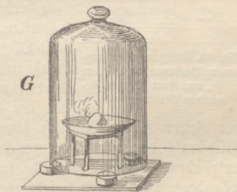
Fig. 100. Langsame Verbrennung von Phosphor.
