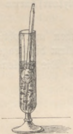
Fig. 65. Auslaugen des Reaktionsproduktes von Kohlensäure und Kalium mit Wasser.
