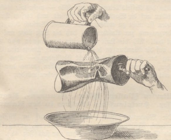
Fig. 40. Der Kessel wird in demselben Augenblick, in welchem sich der Wasserdampf infolge der Abkühlung zu flüssigem Wasser verdichtet, durch das Gewicht der Luft zusammengedrückt.
