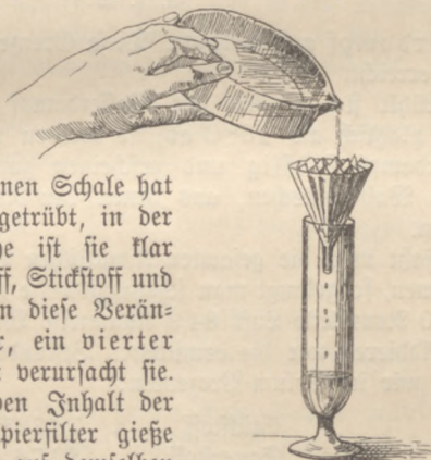
Fig. 36. Das an der Luft trüb gewordene Kalkwasser wird auf ein Papierfilter gegossen, auf demselben bleibt ein fester, weißer Körper zurück.
