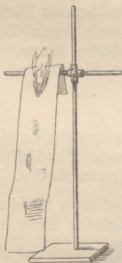
Fig. 101. Übergang einer langsamen Verbrennung in eine rasche, von einer Flamme begleitete Verbrennung.
