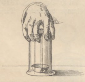
Fig. 86. Löschen einer Flamme durch Abschließen der Luft.
