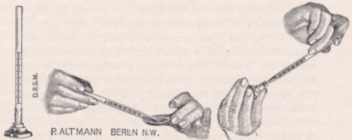
Fig. 1. Einfaches Mikrohämosedimeter (D. R. G. M.) nach F. Roulet zur Bestimmung der Senkungsgeschwindigkeit der Erythrozyten (vgl. Med. Welt 1928 H. 19).
