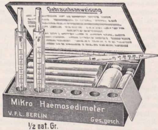
Fig. 2. Mikrohämosedimeter nach H. Langer und W. Schmidt D. R. G. M. (vgl. Z. Kinderheilk. 1926 Bd. 41 H. 1/2). Verwendung geringster Blutmengen. Kein Aufsaugen mit dem Mund, nur Kapillaritätswirkung. Quecksilberschluß gegen Auslaufen. Kleinstes Taschenformat, daher leicht transportabel. Einfache Ausführung der Methode. Mit ausführlicher Gebrauchsanweisung 12 M.
