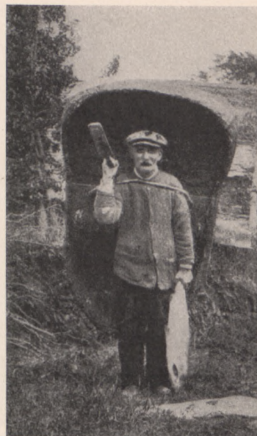
9. Moderner Firbolg. Das 'Coracle' der Fischer von Carmarthen, Cardigan, Llangollen besteht aus einem leichten Gestell aus Eschenholz und Weidenruten, das mit geteertem Segeltuch überzogen ist.
