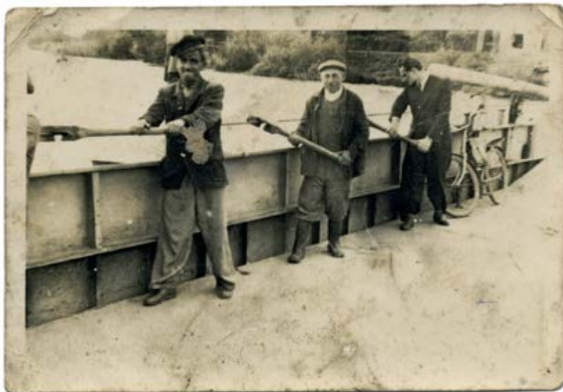
Il. 6. Przewoźnicy na promie demonstrują prowadzenie promu przez Nogat za pomocą drewnianych „pał”, Kępki, lata 50. XX w. Ze zbiorów prywatnych, fot. N.N.
