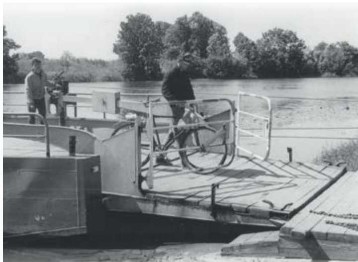
Il. 8. Prom „Jan II”. Wyraźnie widoczna lina nośna i zapętlo- na lina napędowa. Kępki, 1995, fot. Artur Trapszyc
