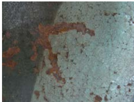
Il. 7. Rozdarcie po sklejeniu i nałożeniu kitu, fot. Justyna Rochon
