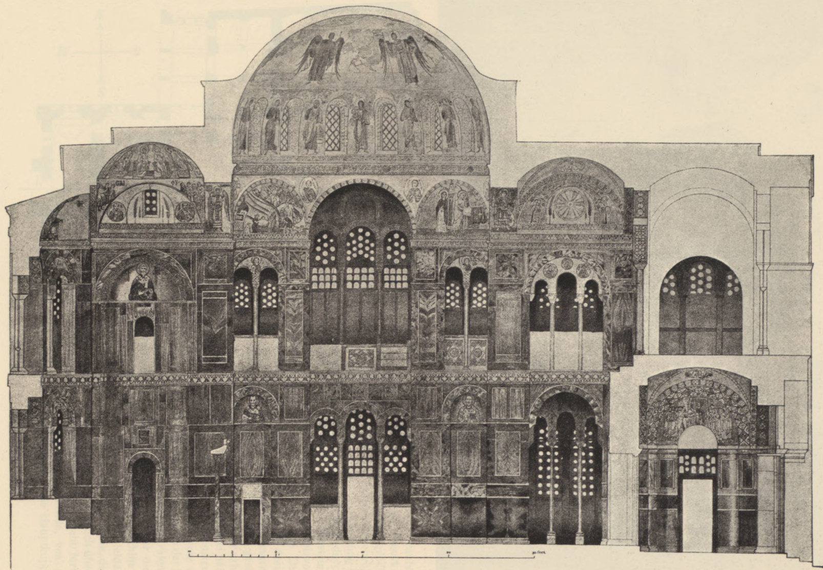
Katholikon von Hosios Lukas (Stiris), Längsschnitt (nach R. W. Schultz and S. H. Barnsley, The monastery of S t Luke of Stiris in Phocis, 1901)
