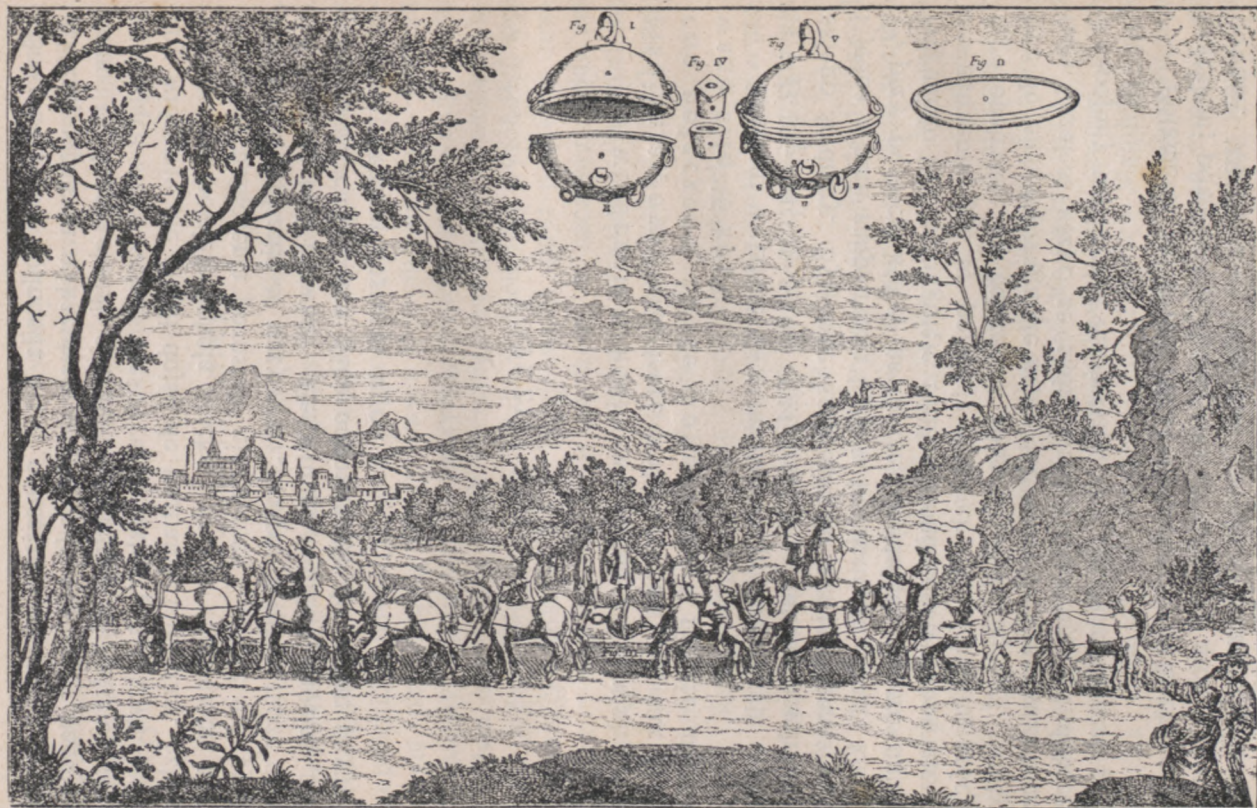
Fig. 14. Doświadczenie z półkulami Magdeburskimi.
