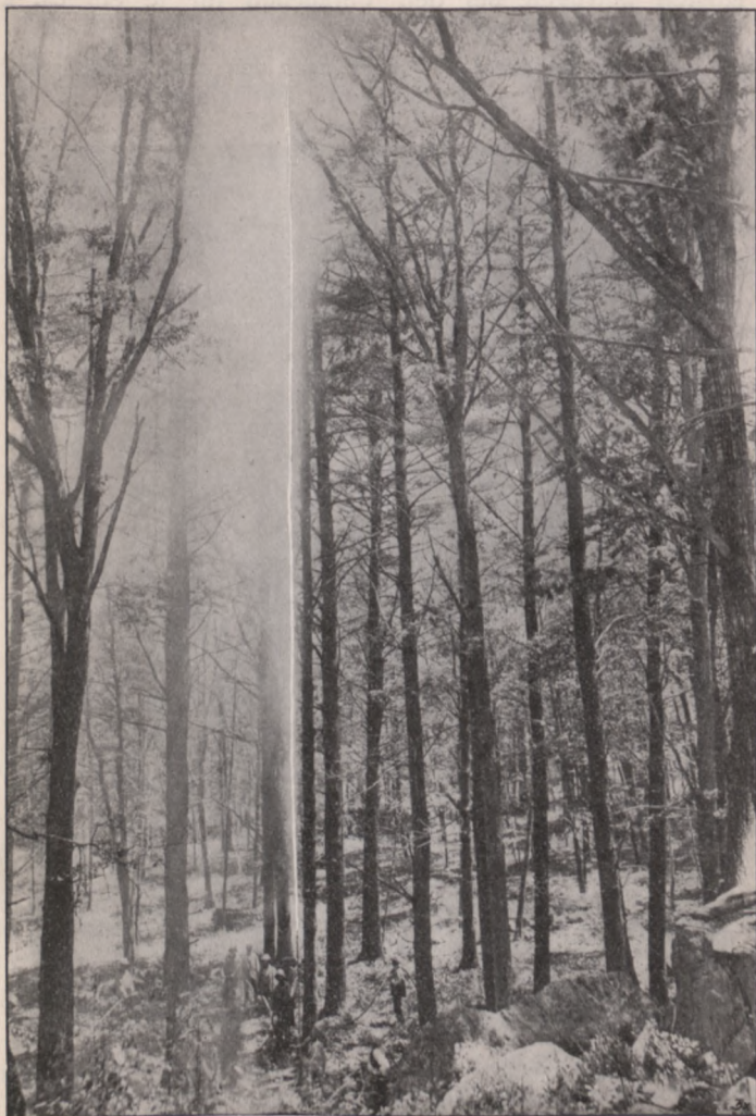
Fig. 218. Spritzen im Hochwald mit einer Motorspritze. Bei 300 m Schlauchlänge kann eine Strahlhöhe von 30 m erreicht werden. (Phot. Fitzhenry-Guptill.) Aus Escherich.
