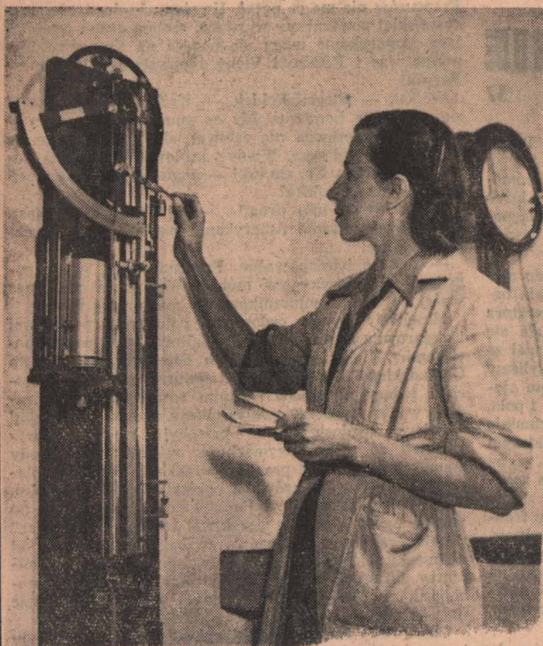
Na zdjęciu: W laboratorium włókienniczym fabryki Helena Strzałkowska bada wytrzymałość wyprodukowanego sztucznego włókna. Foto — CAF
