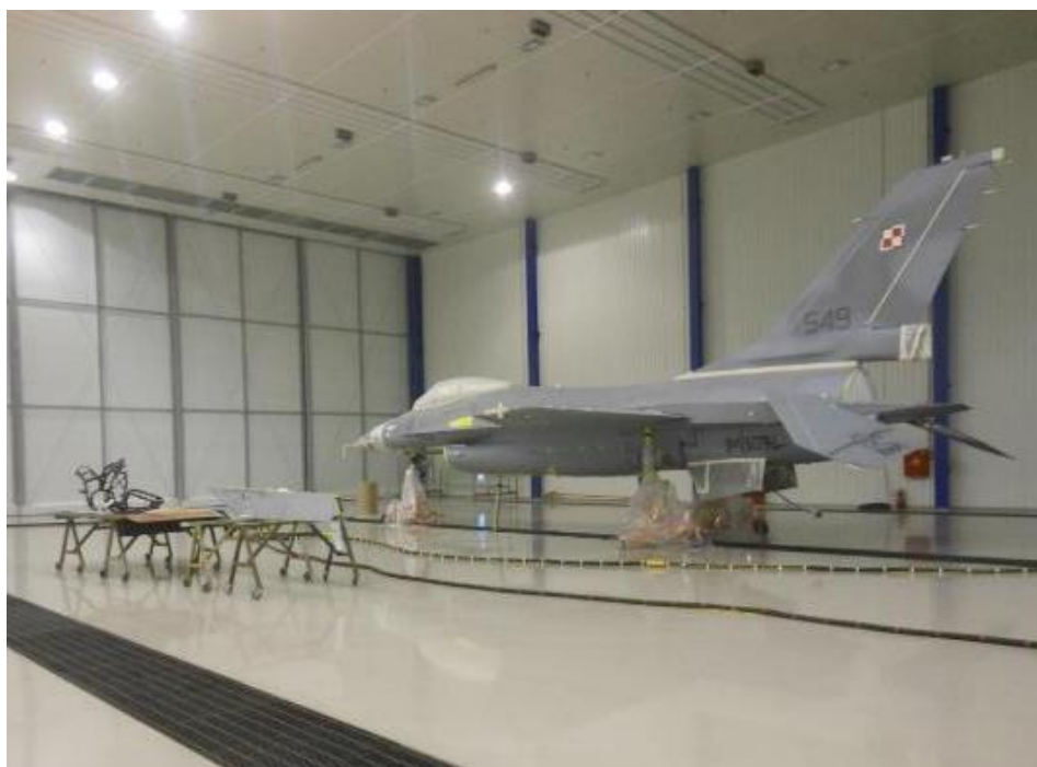
Ryc. 22. Przygotowanie samolotu F-16C do zabiegu usuwania powłoki lakierniczej metodą śrutowania na sucho Plastic Media Blasting (PMB) w specjalnie zbudowanym do tego hangarze w WZL Nr 2 S.A., 2013 r. (fot. z materiałów promocyjnych WZL Nr 2 S.A.)
