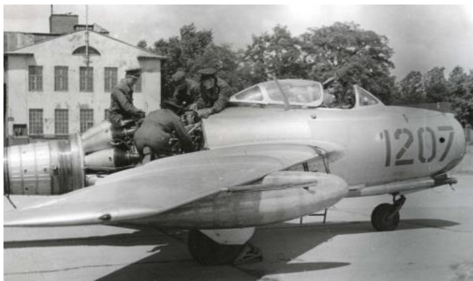
Ryc. 13. Rozstykówka Lima-1, czyli przegląd silnika w licencyjnej wersji myśliwca MiG-15; w tle budynek główny LZR Nr 2, 1957 r. (fot. ze zbiorów autora)
