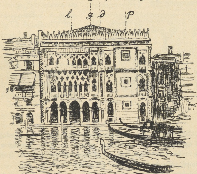
Asymetryczna fasada Ca' d'Oro w Wenecji. g=os symetriji gmachu l=os symetriji części lewej p=os prawej d=dzielnica.
