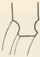
Fig. 44. Kraśnik, kościół, profil żebra. Rys. Szyszko-Bohusz.
