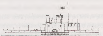
HETMAN ŻÓŁKIEWSKI, statek sztabowy-holownik inspekcyjny; zbud. w 1885 r.; 2 c.k.m.; maszyna parowa 60 KM, bocznołowiec; 25 x 3,5 x 0,6 m; 15–20 ludzi.
