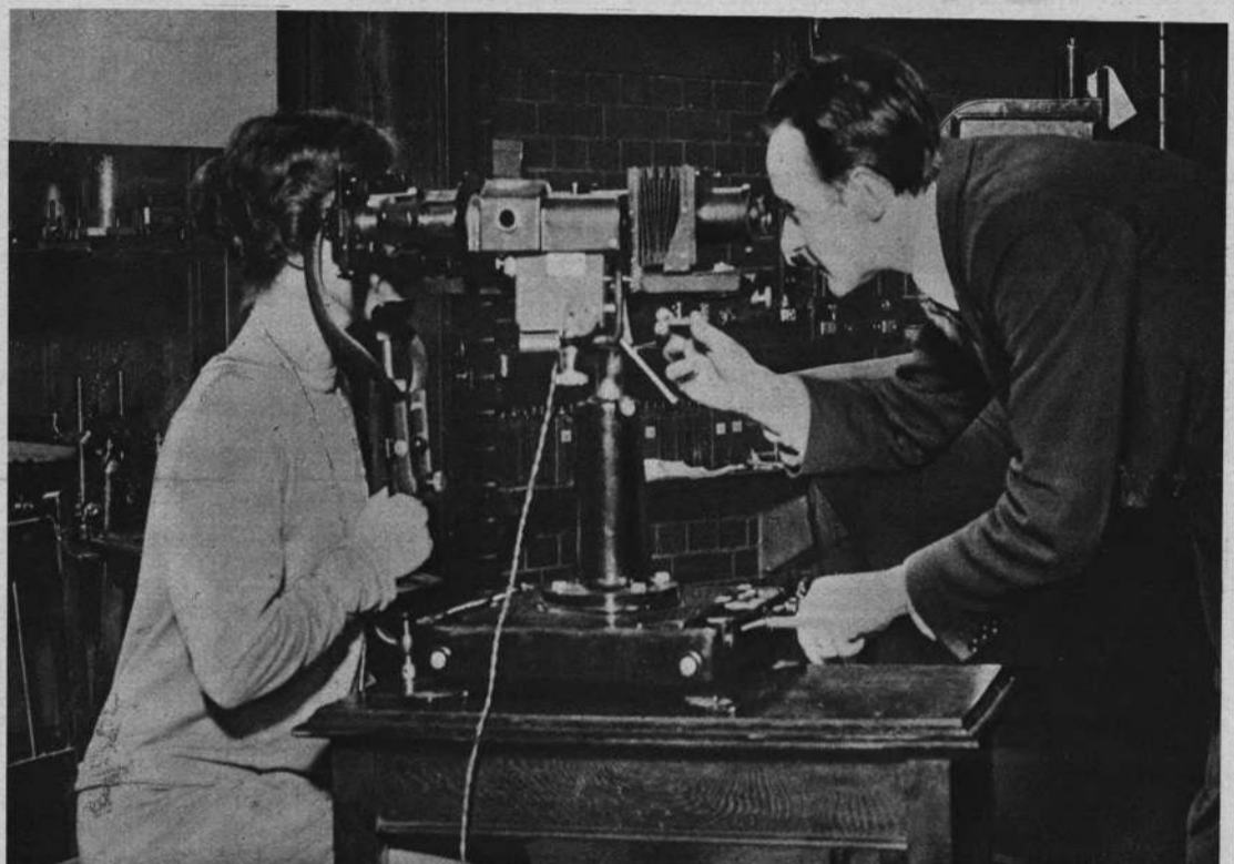
Wynaleziony ostatnio aparat „Oftalmoskop”, który pozwala lekarzowi robić zdjęcia fotograficzne wewnątrz oka pacjenta.
