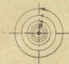
Rys. 106 Kierunek strumieni magnetycznych, gdy prąd płynie przez przewodnik w kierunku widza
