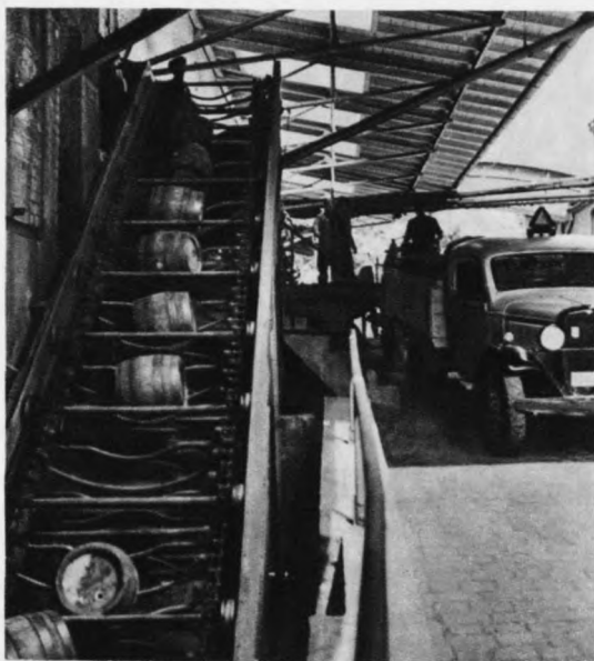
Auf selbsttätigen Treppen und Rollbahnen werden die gefüllten Fässer zur Laderampe geleitet.
