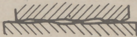
Rys. 127 a i b Gładkie powierzchnie przylegają całkowicie; niegładkie opierają się na grzbieciek pagórków
