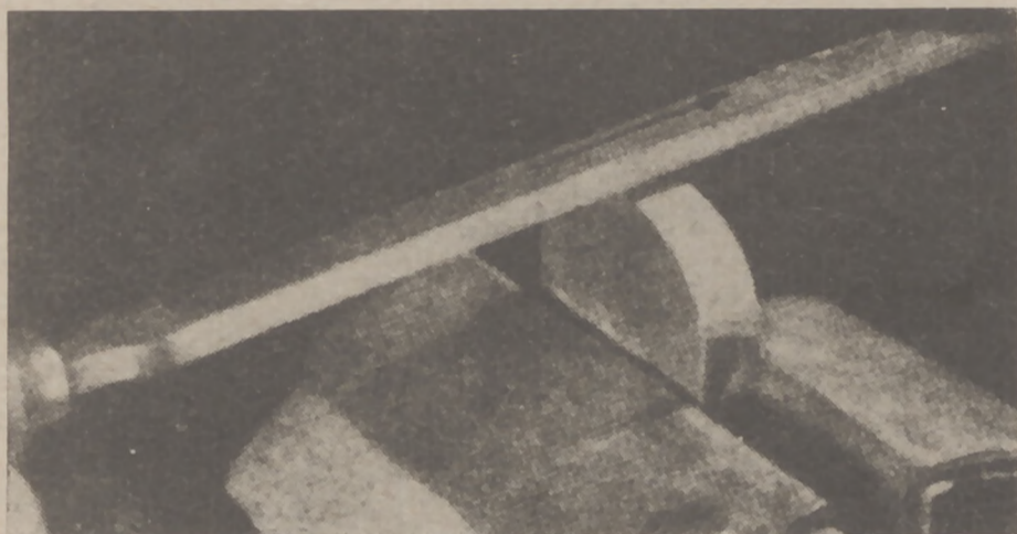
Rys. 120 Powierzchnie krzywe zdzieramy wpoprzek
