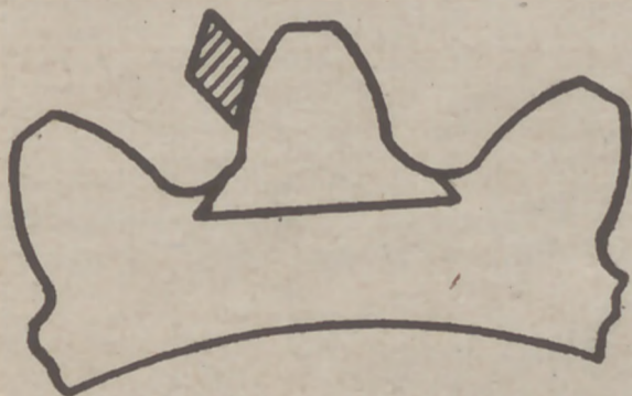
Rys. 54 d Wstawiony ząb dopilowujemy pilnikiem i sprawdzamy kształt szablonem
