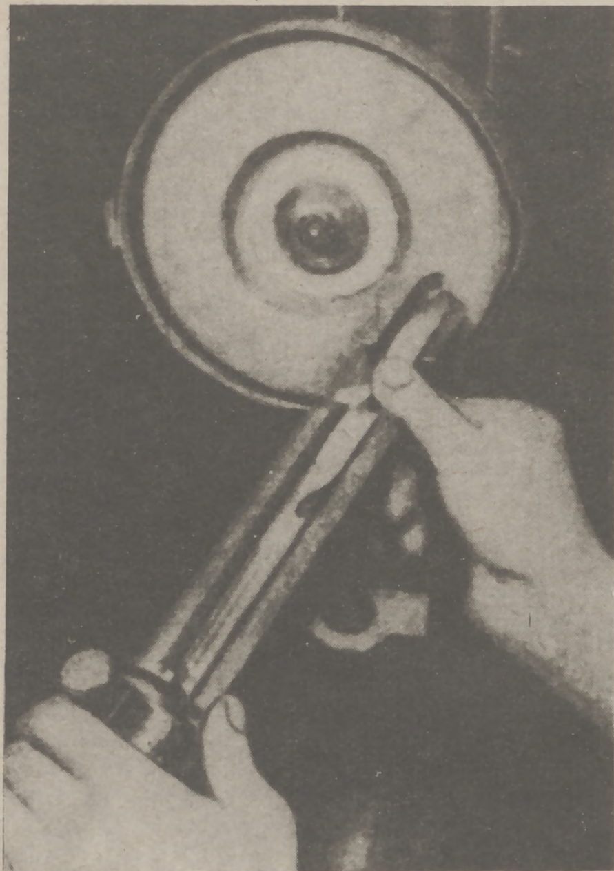
Rys. 142 Ostrzenie wiertel w przyrządzie
