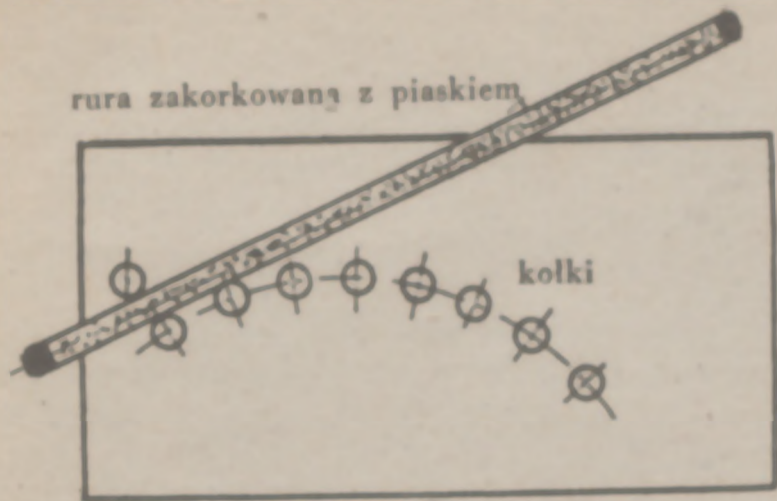
Rys. 202 Zginanie rury według krzywizny wyznaczonej kolkami
