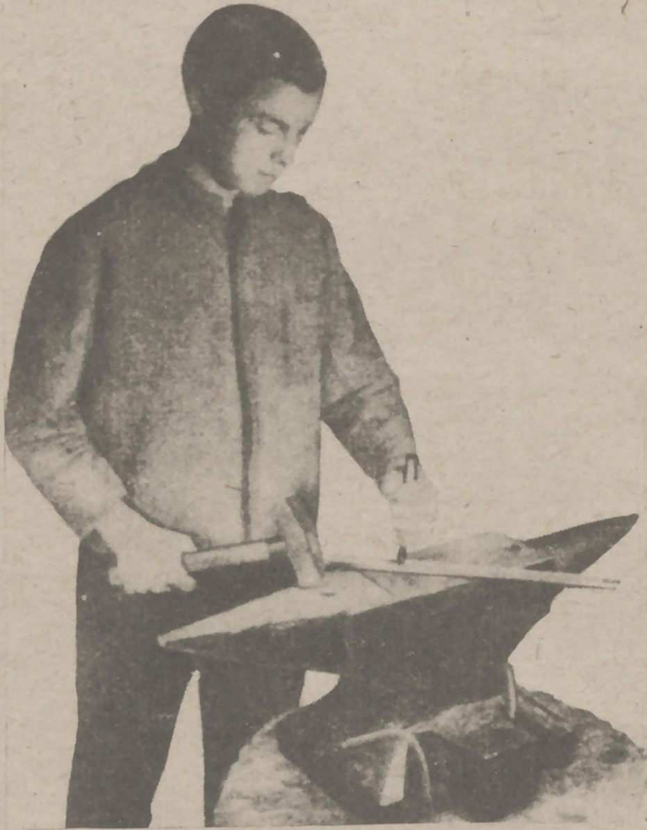
Rys. 85 Przecinanie przecinakiem na kowadle
