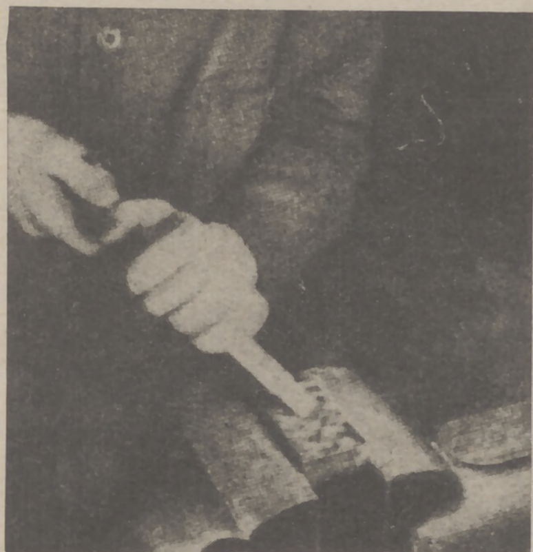
Rys. 131 a Skrobanie płaszczyzny. Prawa ręka prowadzi skrobak, lewa naciska
