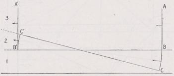
Fig. 149.—Inferior acoustical mirage.
