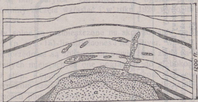
Rys. 16. Przekrój przez pole Spindletop, Texas. a — sól, b — gips, c — wapień (według Lee Hager).
