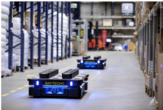
Rys. 1. Autonomiczne wózki transportowe wykorzystywane w magazynie [4]
