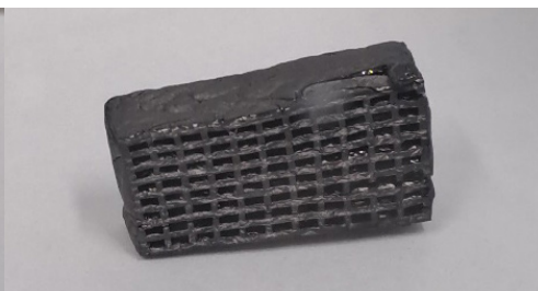
Rys. 11. Prekursory wykonane z żywicy SLA po obróbce termicznej: a) próbka OP1; b) próbka OP2
