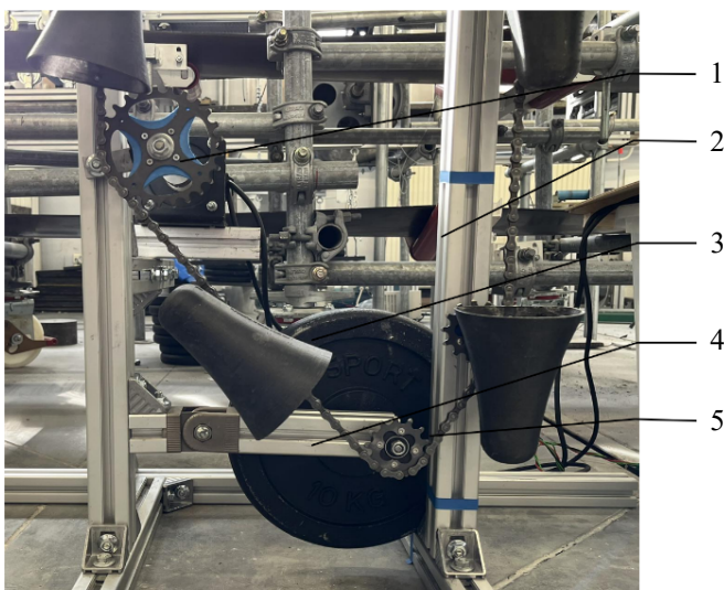
Rys. 9. Stanowisko do badań wpływu siły napinającej na opory ruchu łańcucha: 1 – koło zębate; 2 – profil aluminiowy; 3 – kubełek; 4 – napinacz grawitacyjny; 5 – koło zębate
