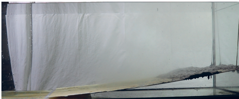
Rys. 9. Z zawiesiny o zbyt dużej koncentracji objętościowej (około 40%) nie udało wytworzyć się prądu zawiesinowego – powstały tzw. kluchy (fot. Z. Ziarek)
