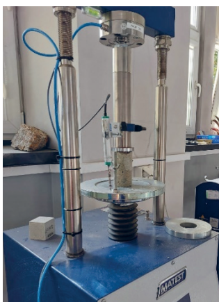
Rys. 2. Przygotowana próbka do badania wytrzymałości na ściskanie w prasie wytrzymałościowej CBR
