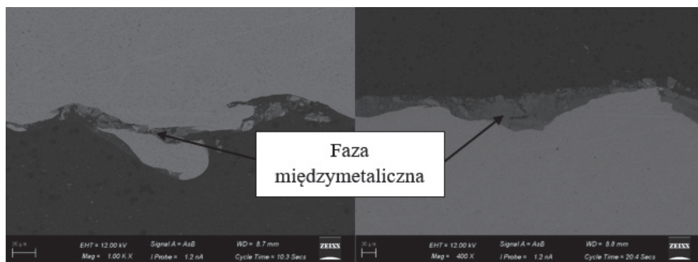
Rys. 9. Złącze stop Al 1050 – tytan Gr. 1, SEM
