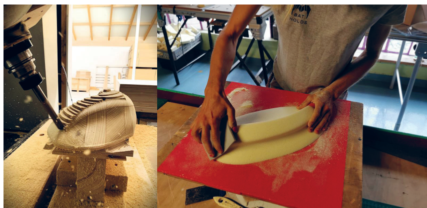
Rys. 15. Porównanie sposobów rzeźbienia prototypów – maszynowo oraz ręcznie
