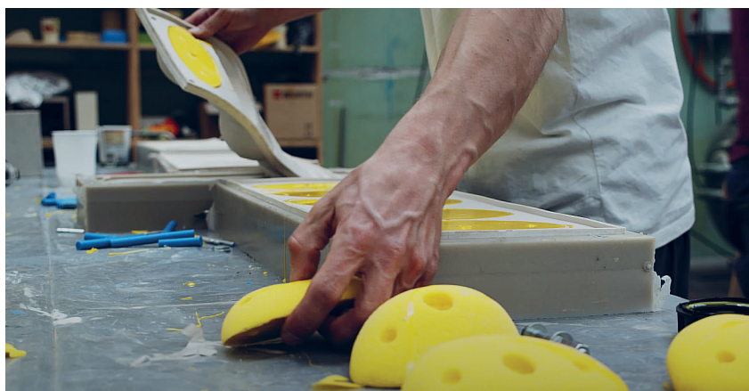
Rys. 22. Wyjmowanie utwardzonych chwytów z form silikonowych
