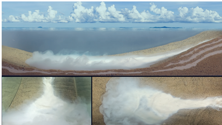
Rys. 12. Prąd zawiesinowy – ujęcie z trzech kamer (fot. K. Kulik)
