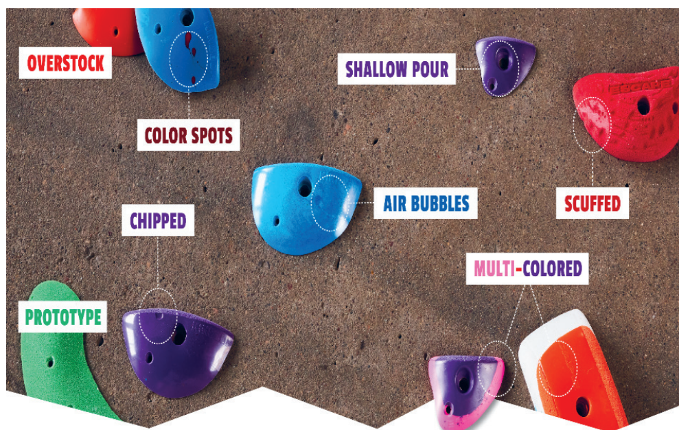
Rys. 30. Przykładowe uszkodzenia kwalifikujące chwytyspinalczkowe jako drugi gatunek
