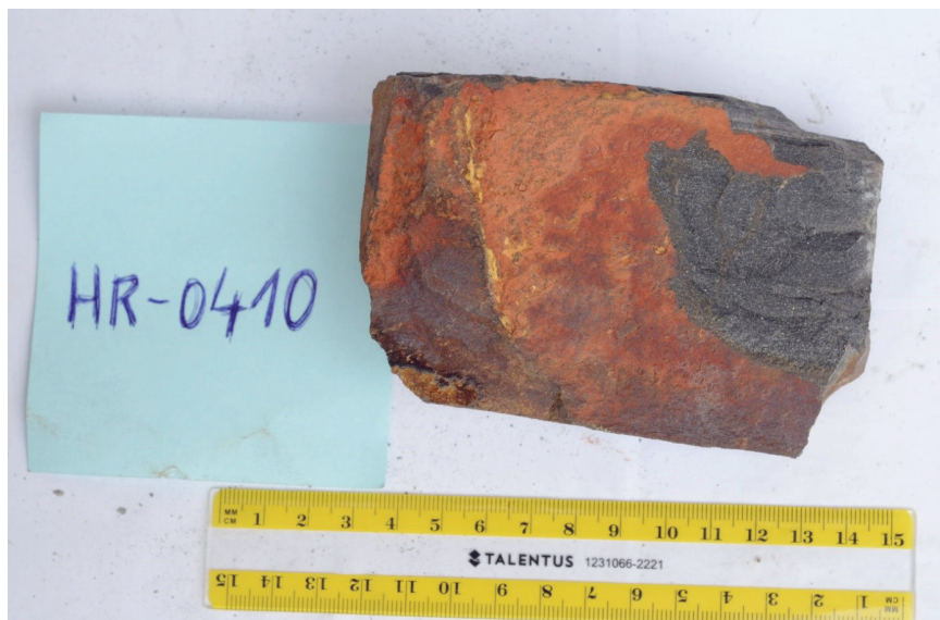
Rys. 2. Próbką piaskowca pobrana w kamieniołomie „Drobny” w Huczwicach z widocznym czerwonym nalotem na powierzchni (fot. J. Szydlowski, SKN „Azymut”)
