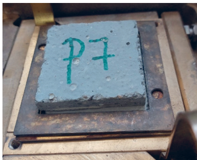
Rys. 3. Prawidłowe ustawienie próbki w aparacie bezpośredniego ścinania
