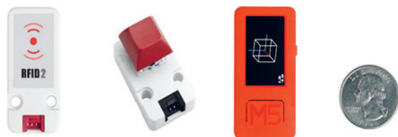
Rys. 11. Moduł deweloperski IoT M5Stack z czytnikiem RFID oraz przyciskiem
