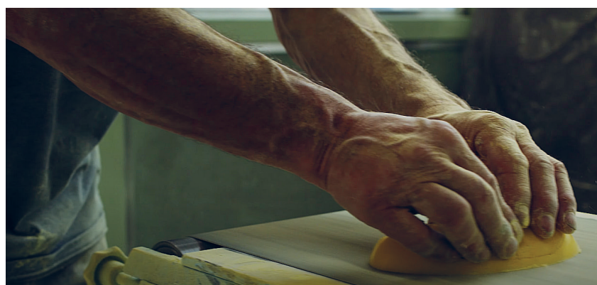
Rys. 23. Szlifowanie krawędzi chwytu
