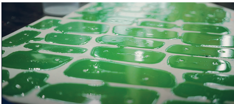
Rys. 21. Forma odlewnicza zalana żywicą, z której uzyskamy cały zestaw chwytów
