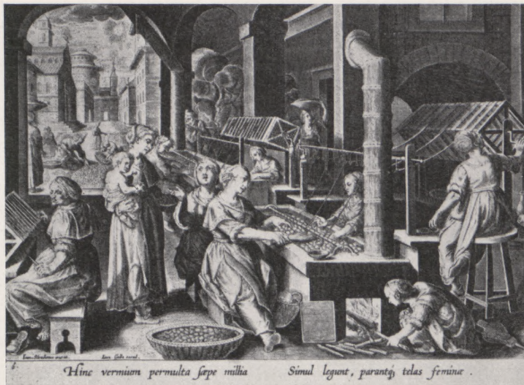
43. Abwickeln des Seidenraupengespinstes. Die Kokons werden in einer geheizten Wasserwanne aufgeweicht, die Seidenfäden aufgewickelt. — Aufblühen französischer Seidenindustrie im 17. Jahrhundert. — Aus einem Colbert gewidmeten Schriftchen über Seidenraupenzucht (1668), mit älteren Stichen von J. Stradan (1605).
