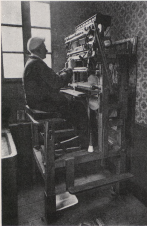
92. Wirkstuhl (métier) im Betrieb. Der sogenannte Rößchenstuhl wurde 1589 durch den Erfinder W. Lee nach Frankreich (Rouen) eingeführt. Obiges Modell: Ränder- bzw. Fangstuhl (von ca. 1860) mit Schußfadenführer und Mustermaschinen aus der alten Bonneterie-Industrie in und um Troyes (Champagne) diente zur Herstellung von Seidenstrümpfen, Handschuhen usw. — Im Député d'Arcis (1847) spricht Balzac über Wirkstühle, die man dort in den Dörfern durch die offenen Haustüren beobachten könne, sowie über die Krise von 1814.
